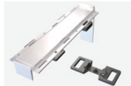
Jeder Halter ist mit einer oder mehreren stapelbaren und quer verschiebbaren Niveauplatten unterlegt. Bei der Montage werden damit das Quergefälle und die Höhenflucht zu den anderen Haltern/Stoßverbindern reguliert.
